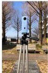
360°動画撮影用カメラ「RICOH THETA SC」三脚に立てて撮影ボタンを押すだけで、360°動画と360°画像が撮れる。周囲の自然音なども録音できる
